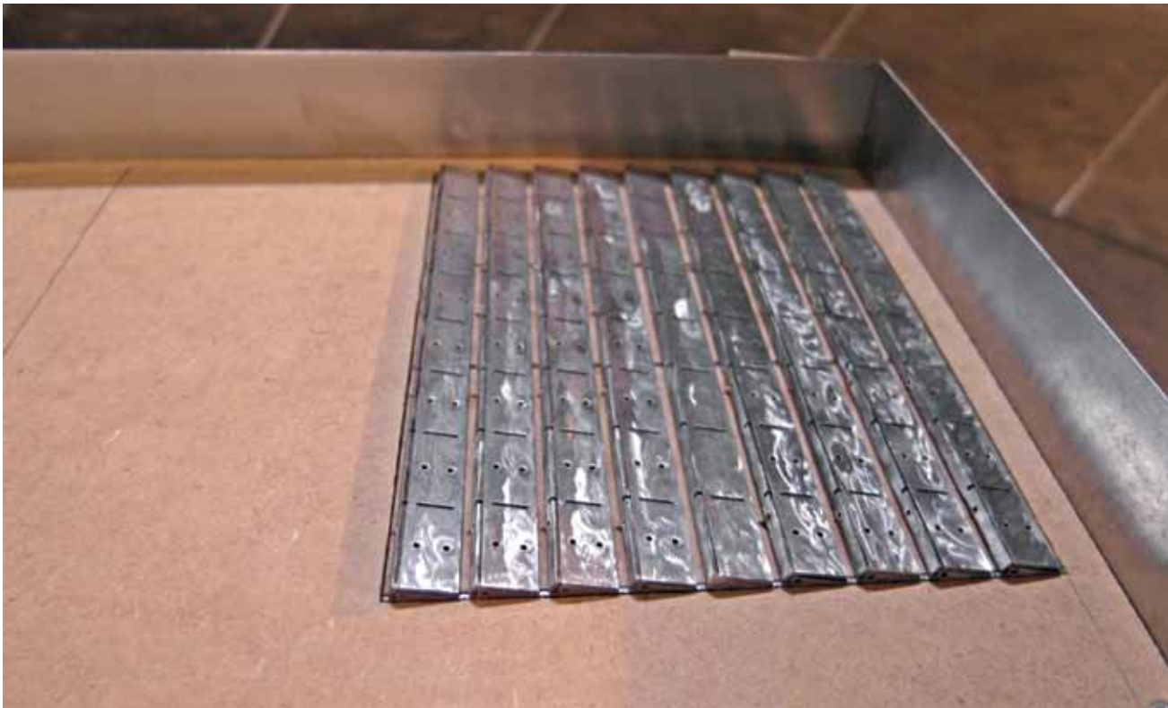
Großaufnahme des modellierten Photovoltaikfeldes. Im Hintergrund ist die ebenfalls modellierte Attika zu sehen.
