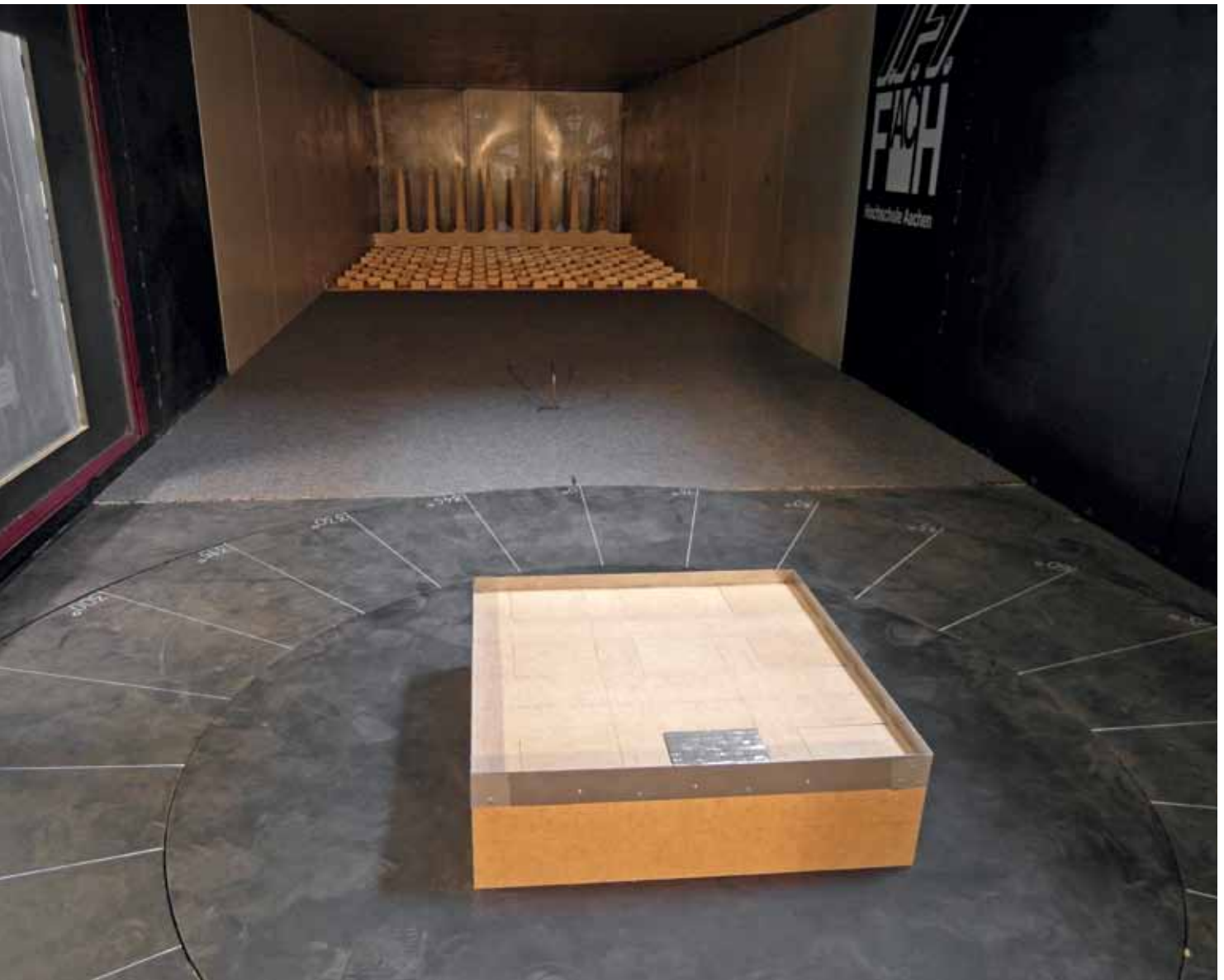
Modell eines Gebäudes mit Flachdach, Attika und Photovoltaikfeld im Maßstab 1:100 im großen Grenzschichtwindkanal des I.F.I.
