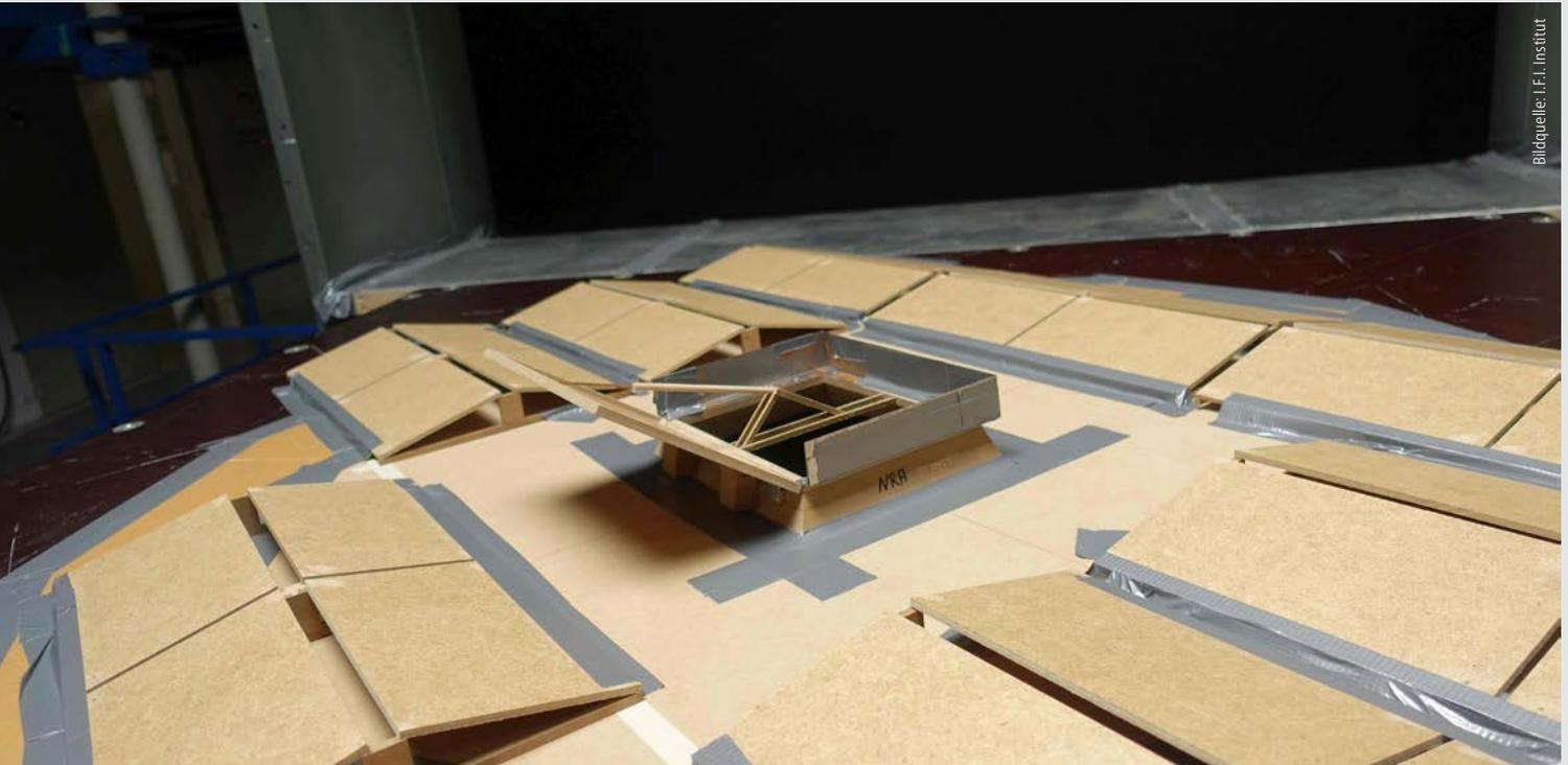
Abb. 1: Modell der NRA und der PVA im Windkanal
